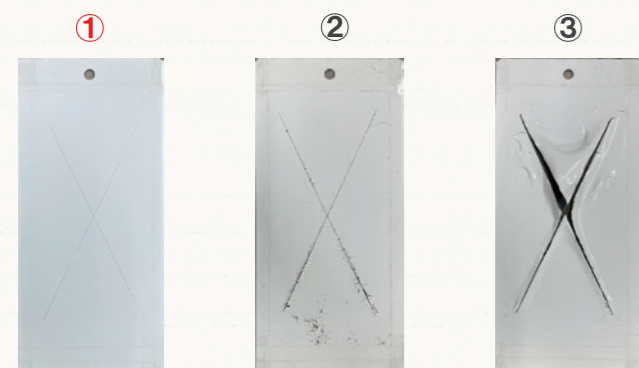
① 下塗り: エポロ G プライマーエコ 上塗り: ハイアート 5000 ② 下塗り: 2 液シリコンエポキシ 上塗り: 1 液フタル酸 ③ 下塗り: 1 液フタル酸 上塗り: 2 液ウレタン
