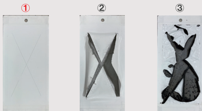
① 下塗り：なし 上塗り：ハイアート 5000 PL 仕様 ② 下塗り：なし 上塗り：2液ウレタン ③ 下塗り：1液フタル酸 上塗り：1液フタル酸
